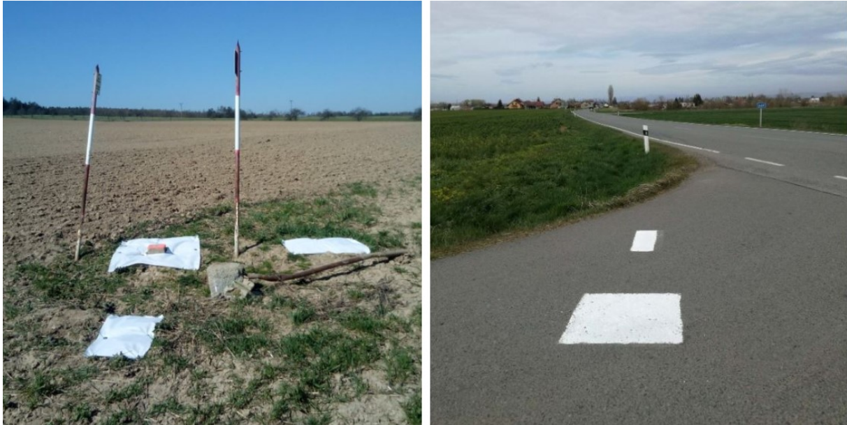
Obr. 5: Ukázka signalizace vlíčovacích bodů v období 2012 - 2020
